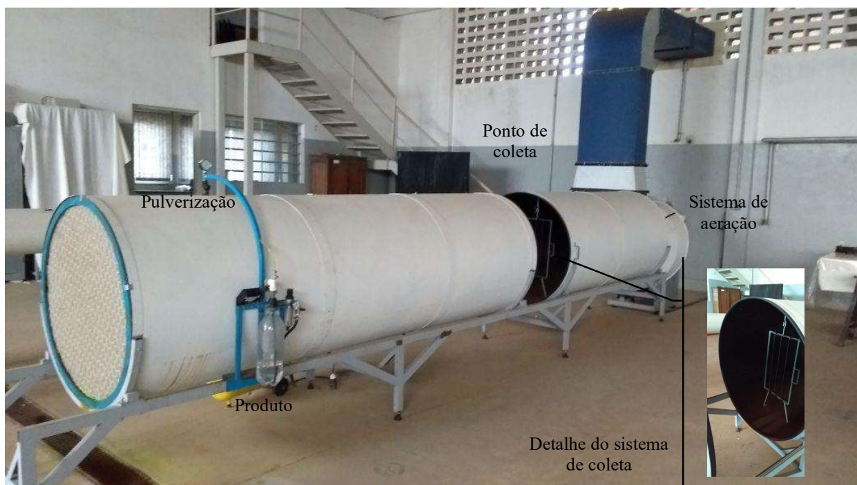
FIGURA 4: Detalhe do sistema utilizado na determinação da deriva da calda evidenciando o protótipo de “túnel de vento” e o sistema de amostragem.
